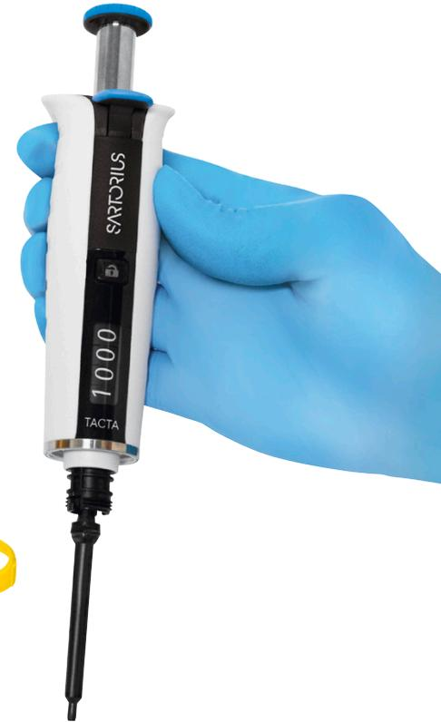
El inteligente diseño de Tacta® solo requiere desmontar tres piezas para su limpieza, lo que hace que el tiempo de desmontaje de Tacta® sea significativamente más corto que el de sus competidores. Esto hace que la limpieza de las pipetas sea una tarea fácil y cómoda, y simplifica el mantenimiento rutinario. La limpieza periódica asegurará unos resultados fiables y prolongará la vida de la pipeta. La prueba se realizó con pipetas de 1000 µl.
