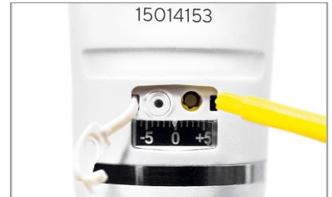
Ajuste de la calibración
