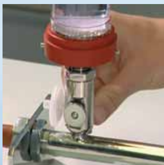
2 | Vakuum anlegen und Probe filtrieren
