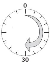
正確な結果を得るためには、天びんが最初に電源に接続されてから、少なくとも30分間のウォームアップが必要です。30分が経過すると、ようやく機器が必要な動作温度に達します。
