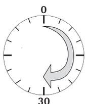
Aby uzyskać dokładne wyniki, waga wymaga przynajmniej 30-minutowego nagrzewania po pierwszym przyłączeniu do zasilania. Dopiero wtedy urządzenie osiąga konieczną temperaturę roboczą.
