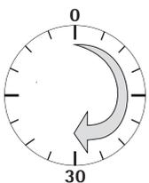
Après le premier raccordement au secteur, la balance a besoin d'un temps de préchauffage d'au moins 30 minutes afin de pouvoir fournir des résultats précis. L'appareil atteindra alors la température de fonctionnement nécessaire.
