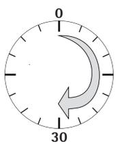
Para obtener resultados exactos, la balanza necesita un tiempo de precalentamiento mínimo de 30 minutos después de conectarla por primera vez al suministro de corriente. En ese momento, el aparato habrá alcanzado la temperatura de funcionamiento necesaria.
