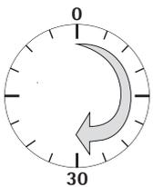
Um genaue Resultate zu liefern, benötigt die Waage eine Anwärmzeit von mindestens 30 Minuten nach erstmaligem Anschluss an die Spannungsversorgung. Erst dann hat das Gerät die notwendige Betriebstemperatur erreicht.
