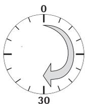
Per fornire risultati precisi la bilancia richiede un tempo di preriscaldamento di almeno 30 minuti dopo il primo collegamento all'alimentazione elettrica. Solo dopo questo tempo l'apparecchio ha raggiunto la temperatura d'esercizio necessaria.
