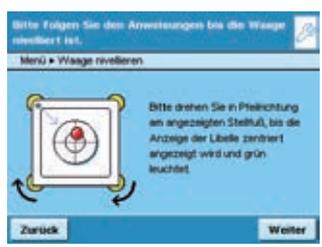
Q-Level bietet die automatische, motorische Nivellierung auf Tastendruck. Dabei hat Cubis® ständig unter Kontrolle, ob die Nivellierung der Waage perfekt ist und meldet dem Anwender sofort, sollte eine Korrektur erforderlich sein (nur für Modelle ≤ 6,2 kg und Ablesbarkeit > 0,001 mg).
