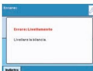
Cubis® offre funzioni di avviso e promemoria con gerarchia delle azioni definibile per livellamento, peso minimo del campione e calibrazione | regolazione.
