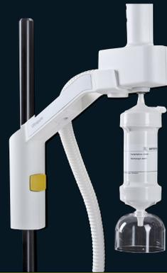
Cell Plus Filter mit einer Abscheidung von 15 kDa entfernt Endotoxine sowie RNase/DNase
