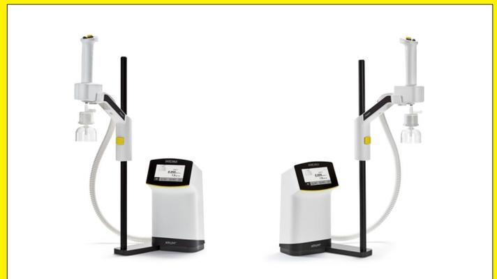
Die Smart Station kann ohne zusätzliches Zubehör problemlos für den Betrieb mit der rechten oder linken Hand angepasst werden.
