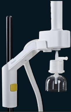
El filtro Sterile Plus con un tamaño de poro de 0,2  $\mu\text{m}$  elimina las bacterias.
