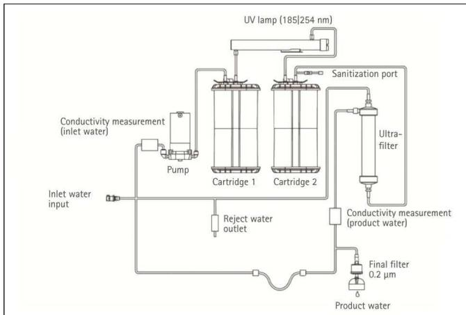
**Figura 4:** Diagrama de flujo esquemático del sistema de agua ultrapura arium® pro VF (para una mayor claridad, se han omitido las válvulas y sus controladores).
