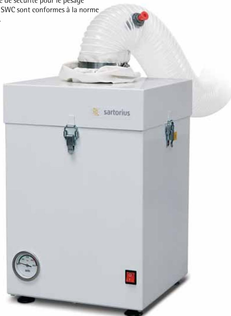
Dispositif de filtrage avec filtre H14 séparé de la cabine pour éviter les vibrations. Système de filtrage « Bag in bag out » permettant de changer le filtre rapidement et sans risque de contamination.
