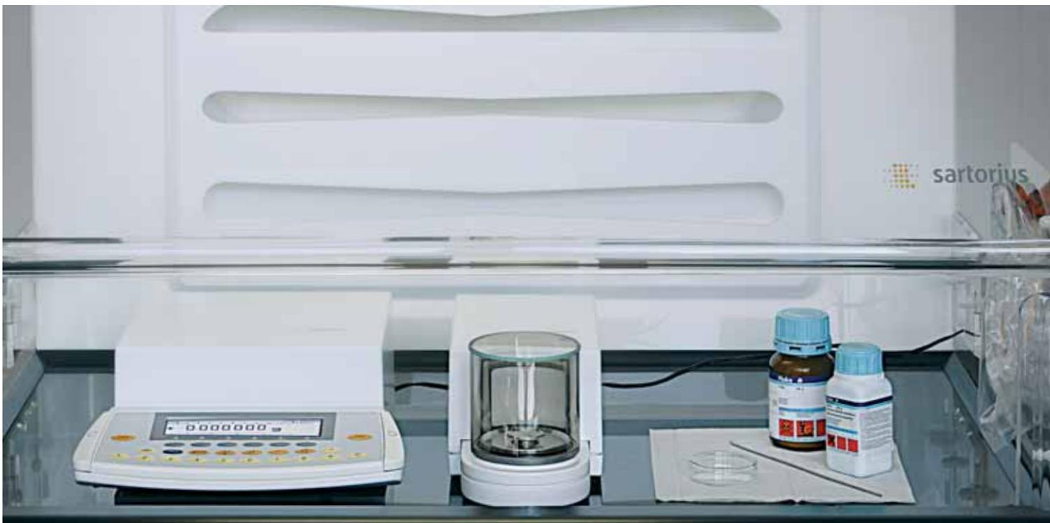
Structure en verre acrylique avec une excellente visibilité de la balance et du produit à peser. Un must lorsque l'on travaille avec de faibles quantités d'échantillon. Les surfaces sont faciles à nettoyer et résistent aux produits de nettoyage courants.
