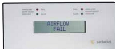
Un système d'alarme calibré du flux d'air avec fonction « Audit trail » vous avertit lorsque la vitesse d'écoulement de l'air est trop faible.
