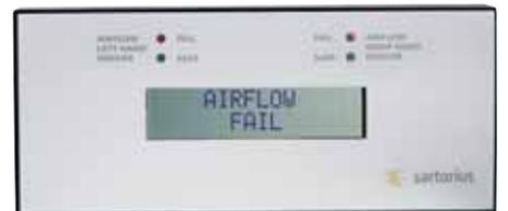
Il sistema di allarme calibrato del flusso d'aria con funzione "Audit Trail" segnala se la velocità di flusso dell'aria scende sotto un livello definito.
