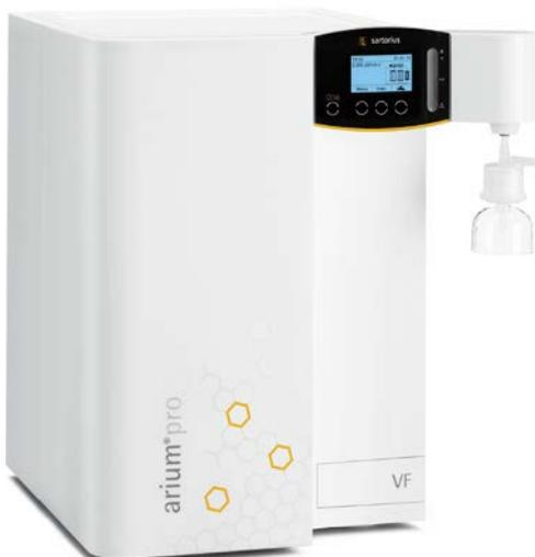
III. 2 : Système de purification d'eau actuel arium<sup>®</sup> pro VF (source : Sartorius Lab Instruments).
