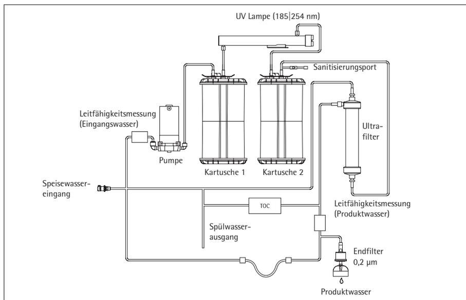
Flussdiagramm arium<sup>®</sup> pro VF TOC
