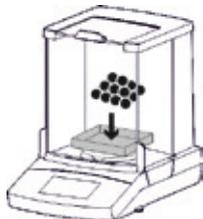
▶ Geben Sie die zweite Komponente auf die Waagschale.
