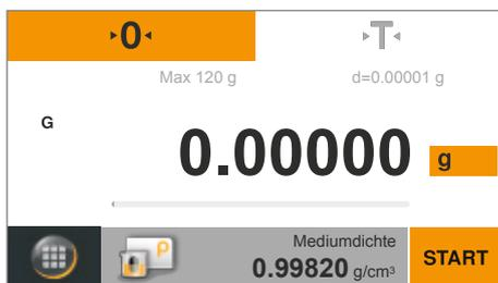
► Die Anwendung **Dichte** erscheint. Unter **Mediumdichte** wird die Dichte der Auftriebsflüssigkeit angezeigt. Die folgenden Werte für destilliertes Wasser bei verschiedenen Temperaturen sind vordefiniert:
