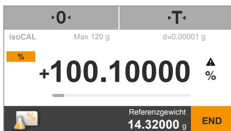
▶ Die Waage zeigt den Prozentwert der Probe bezogen auf die Referenzprobe an.
