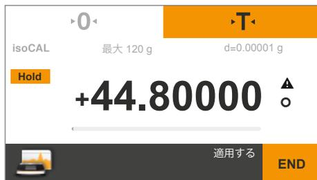
▷ 測定された最大ひょう量値が表示され、サンプルを天びんに載せている限り維持されます。
