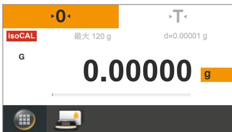
▷ 前回の校正／調整後に周囲温度が変化した場合、あるいは事前に設定されていた時間的な間隔が経過すると、ディスプレイに赤いisoCALボタンが表示されます。
