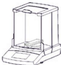
▶ 適宜、ひょう量皿に追加サンプルを載せ、入力された係数をそのひょう量に掛けます。
