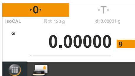
▷ どの型式でも、電源を入ると最初に水平調節画面が表示されます。必要に応じて、天びんを水平に調節します。実際のひょう量画面は確定した後に表示されます。
