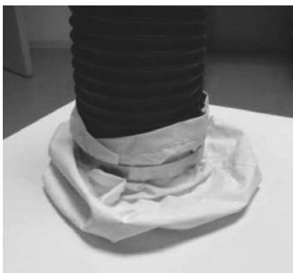
1. Seguir las técnicas de una manipulación manual cautelosa y sacar el filtro de su embalaje. No tocar el medio del filtro. Poner el filtro en el sistema de filtración y ventilación con la manga del filtro mirando hacia arriba.
