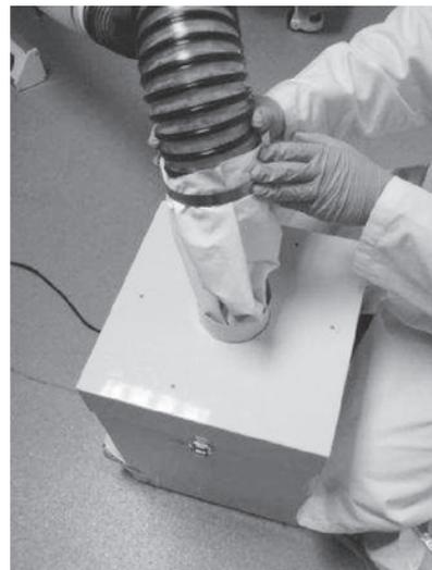
NOTA: El interior de la manga extendida debería estar considerablemente menos contaminado que el conducto y el interior del saco de filtro, ya que hay una exposición muy limitada de impurezas que pasan a través del conducto dentro del saco de filtro.
