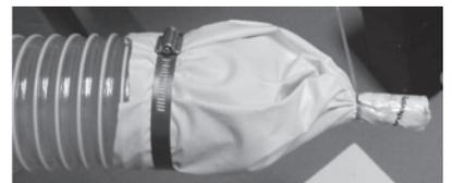
Retirar ahora la tapa de la unidad de ventilación, dejando el conjunto de filtro sellado en su lugar en el armario. Ahora puede desmontarse el filtro de manera segura.
