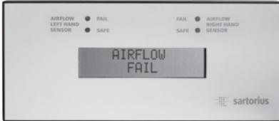
La pantalla de la alarma para el flujo de aire de Sartorius monitorea el flujo de aire entrante en la cabina de seguridad para pesaje e indica si hay o no una condición fiable de flujo de aire para el operador que usa el sistema. No se debe utilizar la cabina para pesaje si la alarma no está conectada o si la pantalla de la alarma indica un error debido al flujo de aire.
