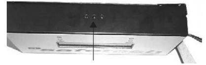
Arriba en la alarma se encuentran tres botones de ajuste de potenciómetro ("pot"). Con el potenciómetro de la izquierda se ajusta el sensor izquierdo, con el central se ajusta el sensor del tubo y con el potenciómetro de la derecha el sensor derecho.
