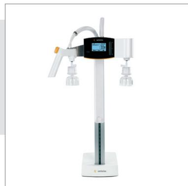
Простой в установке стерилизующий капсульный фильтр arium® SterilePlus с размером пор 0,2 мкм гарантирует стерильный разбор воды без попадания каких-либо частиц.
