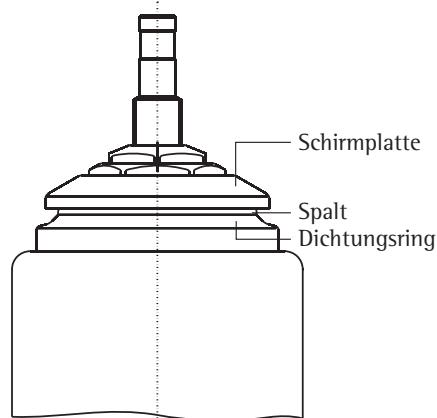
Die Zelle hat im normalen Wägebetrieb IP44. Dieser Schutzgrad ist bedingt durch einen Spalt zwischen der Schirmplatte und dem Dichtungsring.
