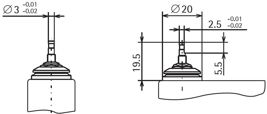
Auf diesen Zapfen kann der Lastaufnehmer z.B. durch Klemmung angebracht werden. Der Lastaufnehmer sollte aus leitfähigem, unmagnetischem Material bestehen um elektrostatische und magnetische Einflüsse zu minimieren. Das Gewicht des Lastaufnehmers muss  $5 \text{ g} \pm 0,1 \text{ g}$  betragen, damit der volle Wägebereich von 20 g zur Verfügung steht. Er muss kleiner als 10 g sein, um die interne Justierung nutzen zu können. Bei einem Transport der Zelle den Lastaufnehmer entfernen.
