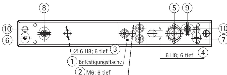
6 und 7 sind Sinterfilter
