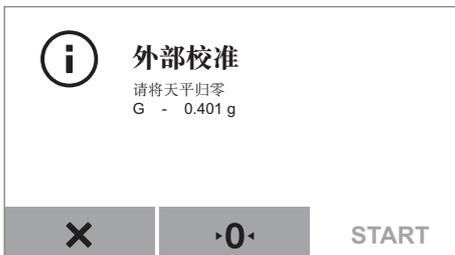
▷ 显示屏上显示一条消息，提示您将标定重量放到水分仪上（50 g）。
