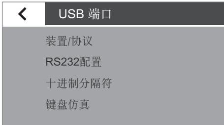
根据与水分测定仪相连的线缆和外围设备, 可在菜单中提供多个选项。水分测定仪会自动检测连接类型。
