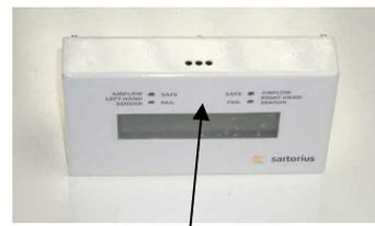
Oben auf dem Alarmmonitor befinden sich drei Einstellknöpfe für die Potentiometer („pot“). Mit dem linken Potentiometer wird der linke Sensor eingestellt, mit dem mittleren der Rohrsensor und mit dem rechten der rechte Sensor.
