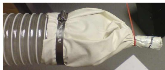
Jetzt können Sie den Deckel der Gebläseeinheit entfernen, wobei die abgedichtete Filterbaugruppe in der Aufnahme im Gebläseschrank belassen wird. Das Filter kann jetzt sicher ausgebaut werden.
