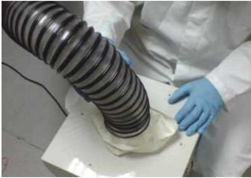
Um dieses Sackmaterial und auf dem Einlassstutzen unter Zuhilfenahme eines Schraubendrehers mit Flachklinge nun eine Schlauchschelle befestigen, um Ablufführung und Sackmaterial in Position zu sichern. Achten Sie darauf, dass die Schlauchschelle sicher sitzt.
