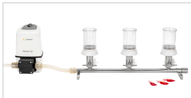
Коллектор Microsart® с мониторами Biosart® 100 и насосом Microsart® e.jet (насос и мониторы не входят в комплект поставки)
