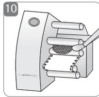
10 Per far fuoriuscire automaticamente la membrana filtrante dal dispensatore Microsart® e.motion, avvicinare le pinzette o premere il pulsante.
