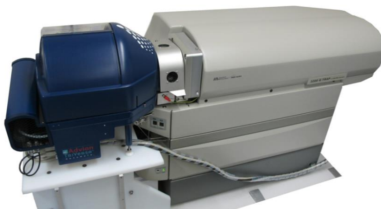
Figura 2. HPLC/nano sistema ESI-MS/MS para análise de jasmonato. Um Biosistema Aplicado/MDS SCIEX 3200 Trap com capacidades híbridos triplos quadro de polo/íon linear foi usado como espectrômetro de massa. Foi assegurada ionização por nano-electrospray (nano ESI) por TriVersa NanoMate, uma fonte de íons à base de chip (Advion BioSciences). O sistema Agilent HPLC não é mostrado (Foto: Departamento de Bioquímica de Plantas, Instituto Albrecht-von-Haller de Ciências Vegetais da Universidade de Georg-August de Goettingen, Alemanha)
