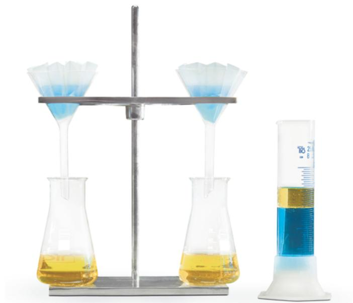
Le grade 480 est imprégné de silicone stabilisé, ce qui le rend hydrophobe : il retient l'eau, mais laisse passer les solvants. Le flux s'arrête automatiquement une fois que le solvant a entièrement traversé le papier filtre. Dans de nombreuses applications, ce papier séparateur de phases peut être utilisé à la place d'ampoules à décanter.
