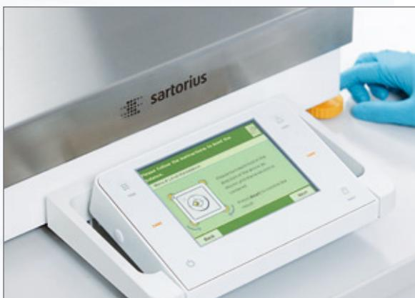
Cubis® monitora continuamente se está perfeitamente nivelada. Nivelamento manual rápido em poucos passos com instruções de orientação interativas ao operador mostradas na tela.
