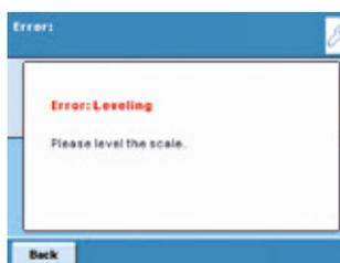
A Cubis® tem funções de aviso e de lembrete em combinação com uma hierarquia de ações configuráveis para nivelamento, determinando o ponto de início da faixa de operação do Capítulo 41 da USP e para calibração | ajuste.
