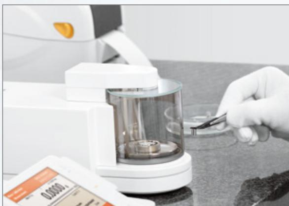
Os comparadores de massa Cubis® MCM possuem uma gama completa de soluções para comparação de massa fornecendo sensores de clima embutidos para temperatura, umidade e pressão do ar, bem como fluxos de trabalho de acompanhamento do usuário e leituras dos resultados juntamente com as incertezas da medição.
