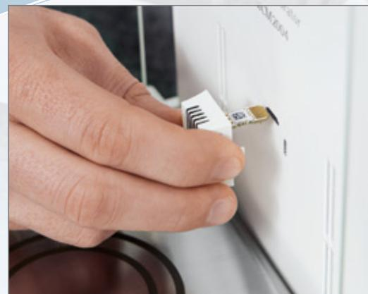
Os sensores de clima para temperatura, umidade e pressão do ar são integrados em uma unidade intercambiável, pequena, compacta e leve. Eles podem ser facilmente removidos para calibração DAkKS.
