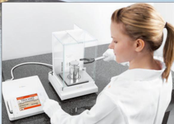
Todos os comparadores de massa Cubis® MCM apresentam uma unidade de controle e exibição com uma unidade eletrônica isolada da célula de pesagem para reduzir os efeitos do calor gerado pela eletrônica e do calor das mãos do operador.
