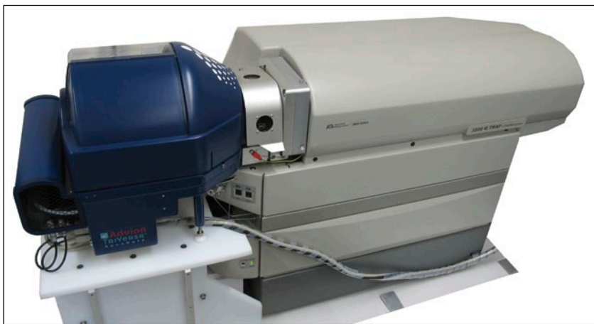
Figura 2: Sistema HPLC/nanoESI-MS/MS para el análisis de jasmonatos. Como espectrómetro de masas, se utiliza el equipo de trampa iónica de triple cuadrupolar/lineal híbrido 3200 de la marca Applied Biosystems. La ionización por nanoelectrospray (nanoESI) se asegura con la fuente de iones basada en chip TriVersa NanoMate (Advion BioSciences). El sistema HPLC de Agilent no se muestra. (Foto: Departamento de Bioquímica de las Plantas, Albrecht-von-Haller-Institut, Universidad Georg-August, Gotinga, Alemania).
