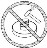
Auf keinen Fall die Farbdose mit dem Hammer verschließen, solange die Farbdose noch auf der Waagschale steht!
