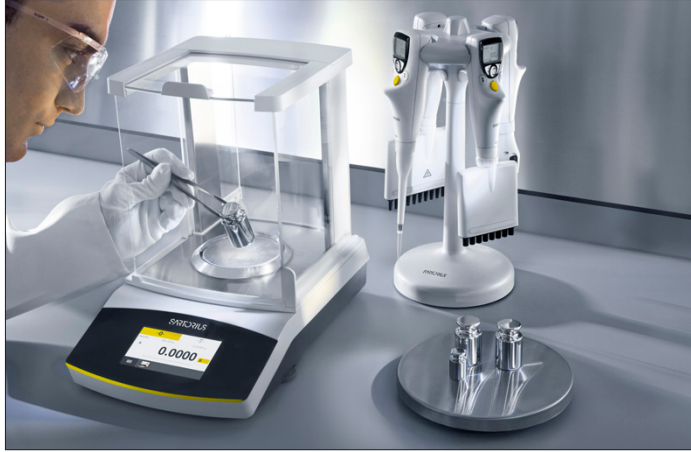
Abbildung 3: Überprüfen der Richtigkeit einer Laborwaage mit externen Prüfgewichten.
