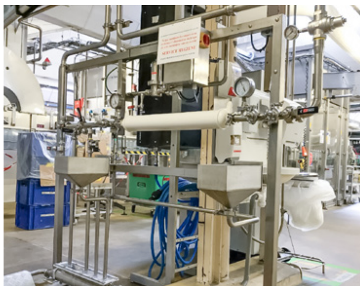
Photo 7 : Filtre Maxicaps® 30" en position horizontale
