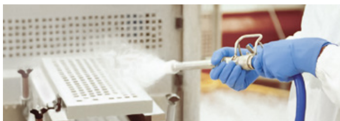
Photo 1 : Flexible de lavage de l'extérieur des machines
