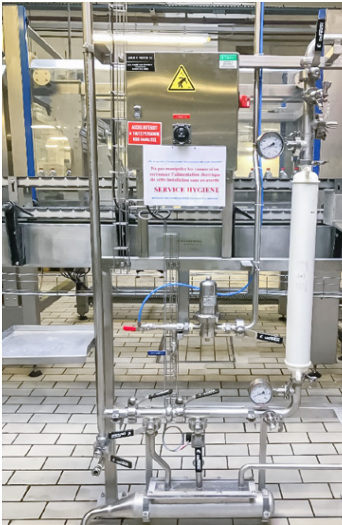
Photo 8: Filtre Maxicaps® 30'' en position verticale
