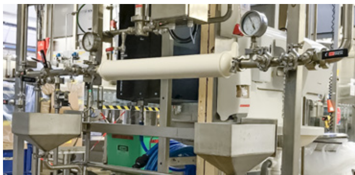
Photo 5B : Installation complète avec une Maxicaps® 30" grade stérilisant en place
