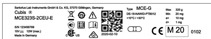
Abbildung 1: Kennzeichnungsschild einer MCE323S-2CEU mit den gesetzlich geforderten Angaben.
