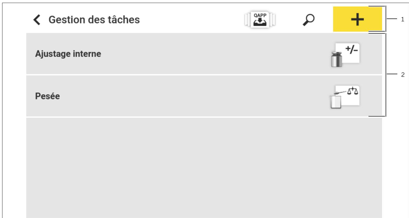
III. 8: Éléments de commande dans la gestion des tâches (exemple)
