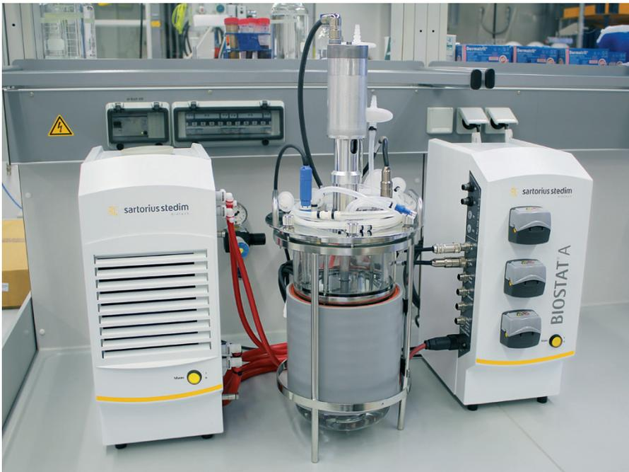
**Figura 1:** BIOSTAT® A configuração para experimento de fermentação de alta densidade celular com *Escherichia coli*
