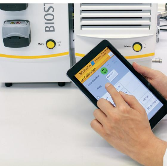
**Figura 2:** Calibração digital das sondas de pH e  $pO_2$
