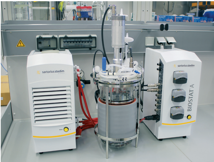
Figura 1: BIOSTAT® La configuración para experimento de fermentación de alta densidad celular con Escherichia coli
