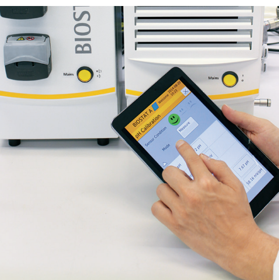
Figura 2: Calibrado digital de las sondas de pH y \text{pO}_2
