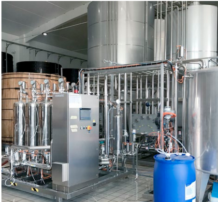
Varvello (Bastiglia, Modena): Sistema 2 automatizado × 4 líneas para la clarificación de vinagre balsámico. 1
