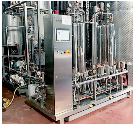
Vicas (Pontassieve, Firenze): Sistema 4 automatizado × 1 línea para la clarificación de vino bruto. 4
