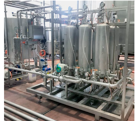
Caviro (Forlì): Sistema 2 automatizado × 3 líneas para la filtración de vino tras la estabilización tartárica estática. 2
