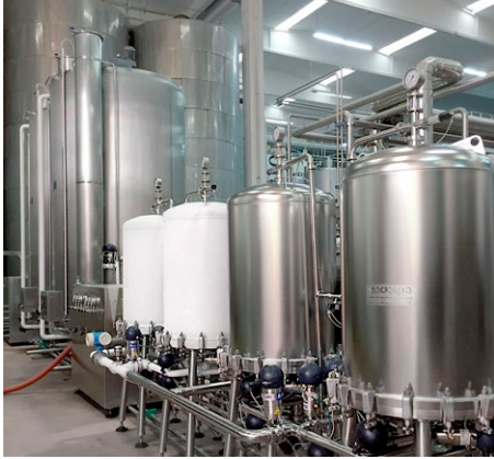
Caviro (Forlì): instalación de carcassas y cartuchos Jumbo Star en dos sistemas Cadalpe® para la estabilización tartárica continua de vino tinto y blanco. 2
