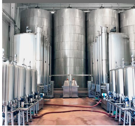
Caviro (Forlì): instalación de carcassas y cartuchos Jumbo Star en dos sistemas Cadalpe® para la estabilización tartárica continua de vino tinto y blanco. 2
