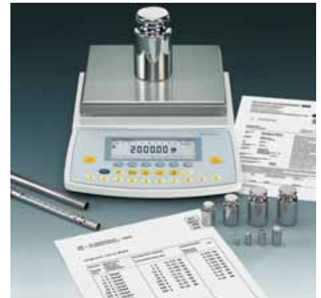
Externe Kalibrierung und Justierung einer Präzisionswaage
